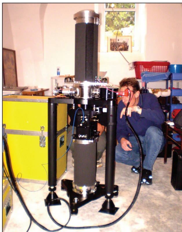
Слика.6.1.1.1. Мерење апсолутног убрзања у манастиру Гретег инструментом FG5
